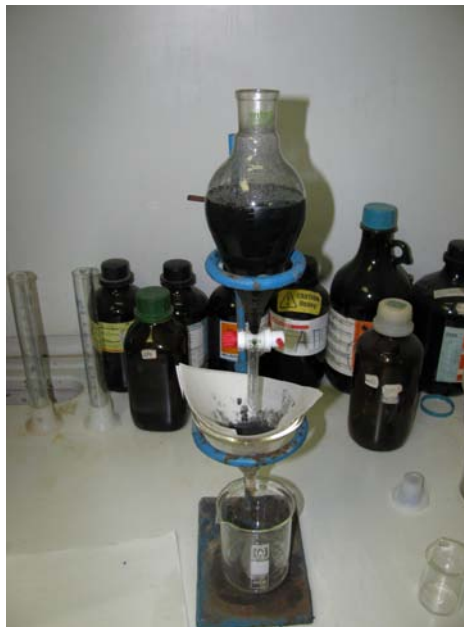
Εικόνα 6.2: Εργαστηριακή μέθοδος βαρέων υγρών σε κωνική φιάλη
