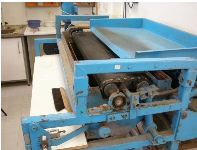
Εικόνα 6.7: Ταινιοφόρος μαγνητικός διαχωριστής Perm–Roll
