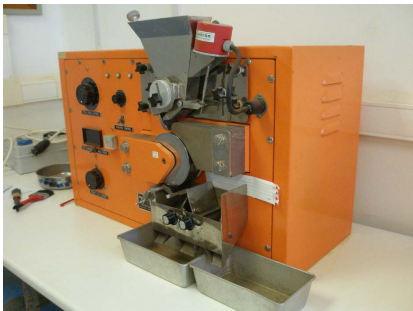
Εικόνα 6.8: Υψηλής έντασης ξηρός επαγωγικός μαγνητικός διαχωριστής (High intensity In-duced Roll Magnetic Separator MIH (13) της Carpco.
