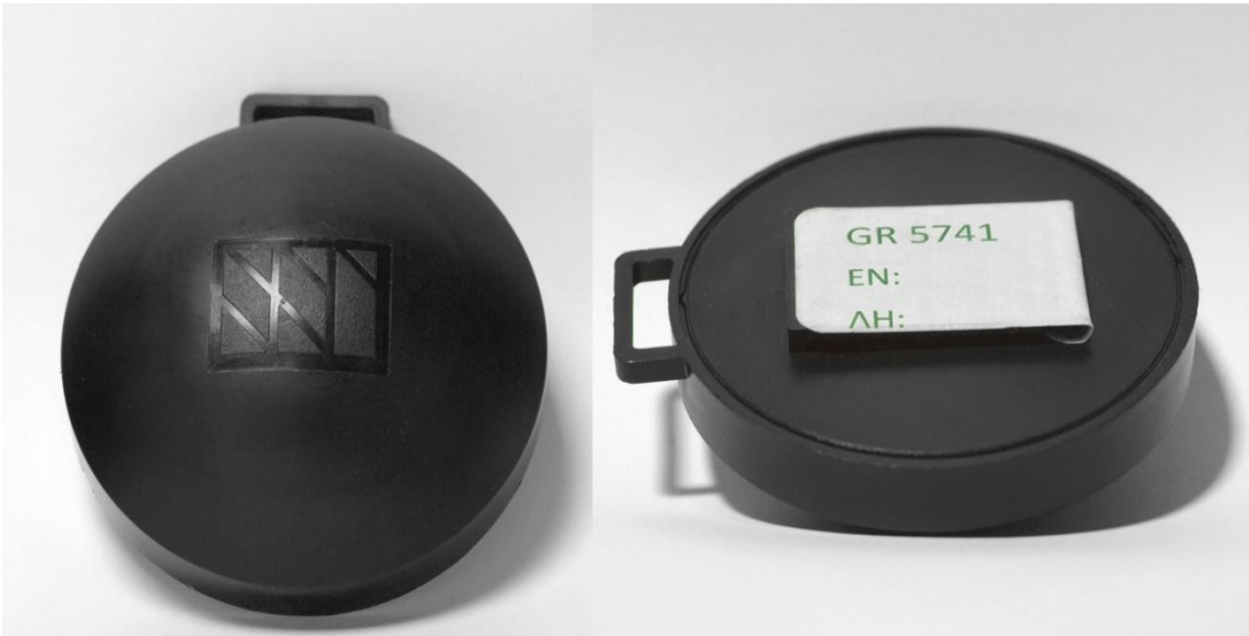
Εικόνα 3.5: Παθητικός ανιχνευτής CR-39 που χρησιμοποιήθηκε στην παρούσα διπλωματική.
