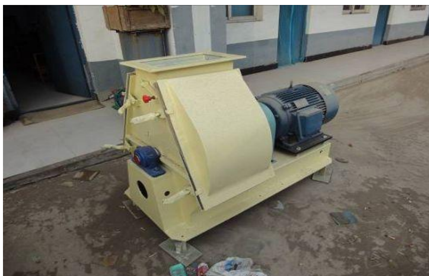
Εικόνα 17 : Σφυρόμυλος άλεσης βιομάζας
