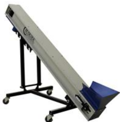
Εικόνα 22 : Ταινία μεταφοράς και ψύξης
