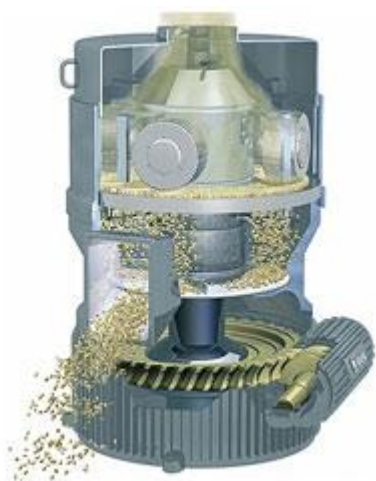
Εικόνα 18 : Τομή επίπεδου μύλου πέλλετ(flat die pellet mill)
