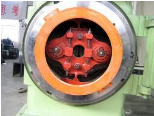
Εικόνα 20 : Κυλινδρικός μύλος πέλλετ(ring die pellet mill)
