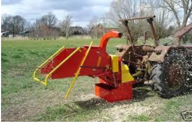
Εικόνα 24 : Καταστροφέας κλαδιών - ΡΤΟ τρακτέρ
