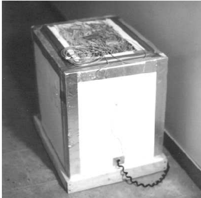
Εικόνα 2. Το κουτί κλειστό. Διακρίνεται η παροχή ρεύματος για την θέρμανση του κουτιού (σπιράλ καλώδιο)
