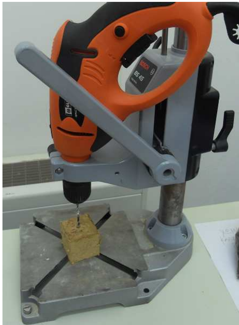
Εικόνα 9. Το τρυπάνι που χρησιμοποιήθηκε για το άνοιγμα των οπών είναι κοινής ακριβείας , συνεπώς οι οπές δεν ήταν πάντοτε απόλυτα κάθετες. Ωστόσο με γεωμετρικούς υπολογισμούς ακριβείας υπολογίζονταν οι αποστάσεις με ακρίβεια ενός δεκάτου του χιλιοστού.
