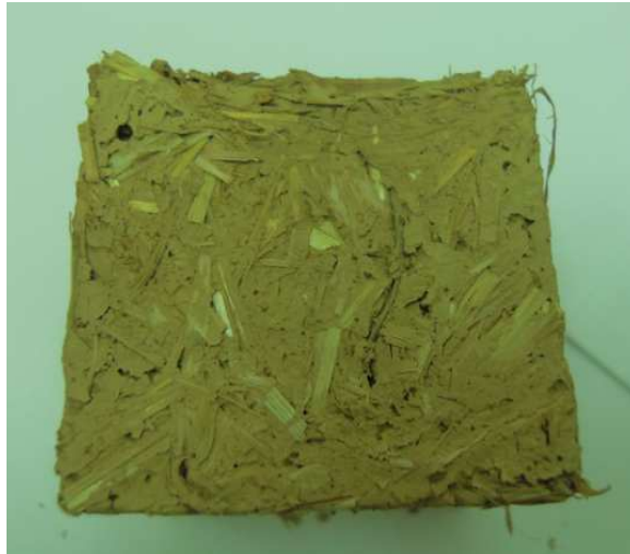
Εικόνα 8. Δείγμα SO (Σούδας) περιεκτικότητας κατ'όγκον 25% χόμα από Σούδα – 75% άχυρο
