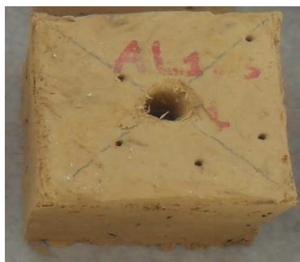
Εικόνα 4. Φωτογραφία δείγματος ωμόπλινθου. Διακρίνονται η κεντρική οπή στην οποία θα τοποθετηθεί κυλινδρική ωμική αντίσταση και οι 5 μικρές οπές στις οποίες θα τοποθετηθούν τα θερμοζεύγη για την μέτρηση της θερμοκρασίας.
