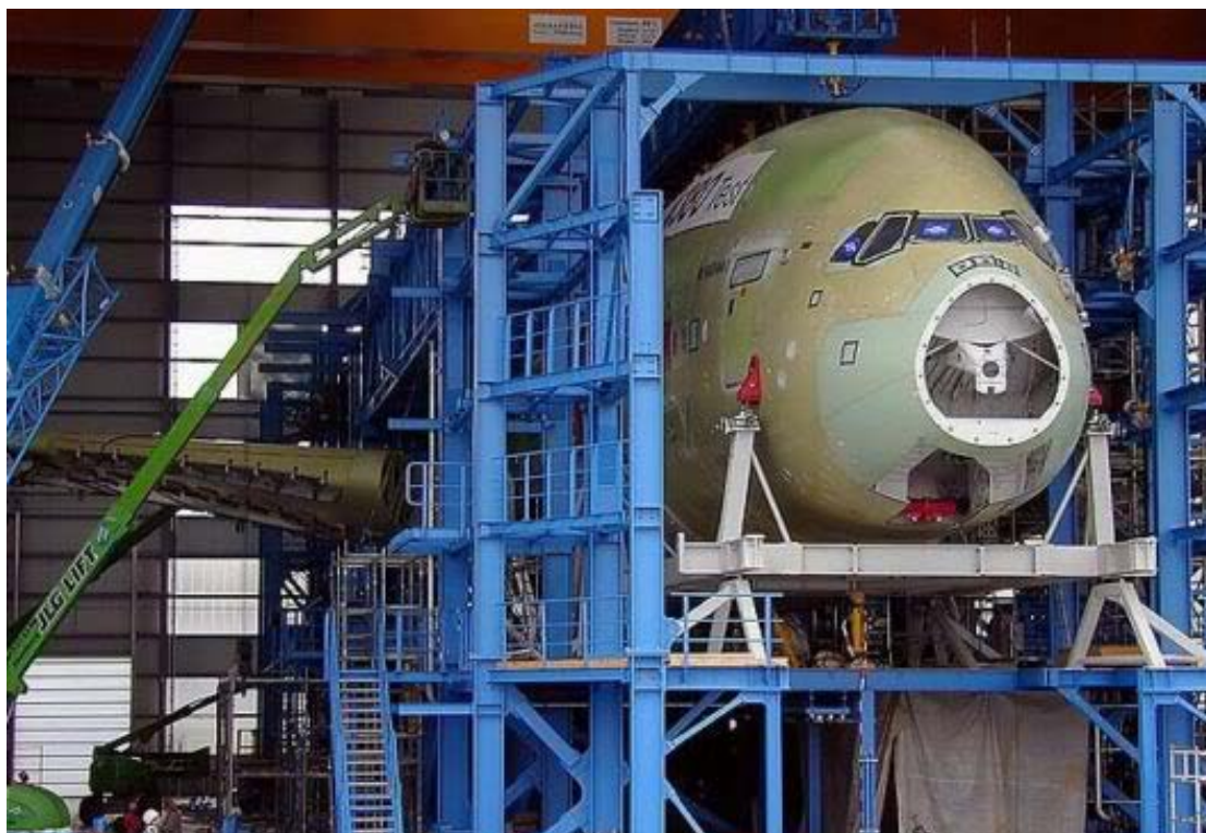
Εικόνα 15: Δοκιμές αντοχής σε φυσικό μοντέλο
