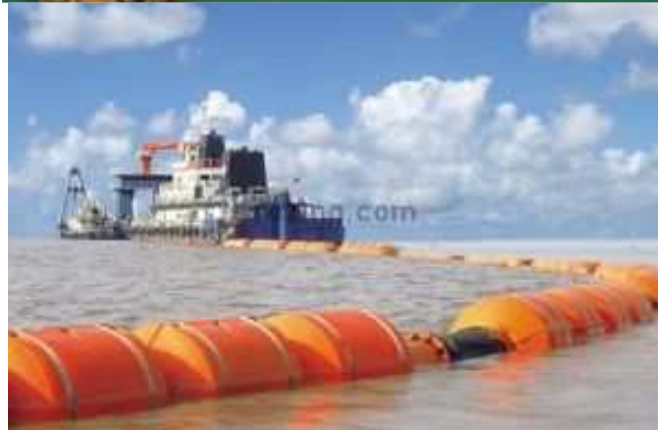
Σχήμα 1. Μεγάλες βυθοκόροι αναρρόφησης όπου το δάνειο υλικό εισέρχεται στο σύστημα άντλησης. Πηγή : www.dubaiglobalvillage.com/palm-island-dubai/about-the-palm-islands/palm-deira.html
