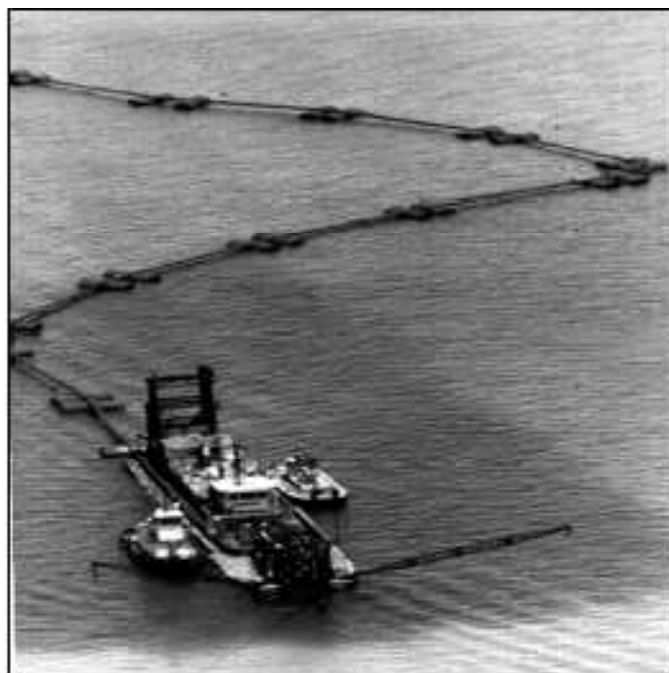
Σχήμα 2. Αεροφωτογραφία που απεικονίζει βυθοκόρο με σύστημα πλωτού εύκαμπτου αγωγού που μεταφέρει το ίζημα στην θέση του έργου εμπλουτισμού.
