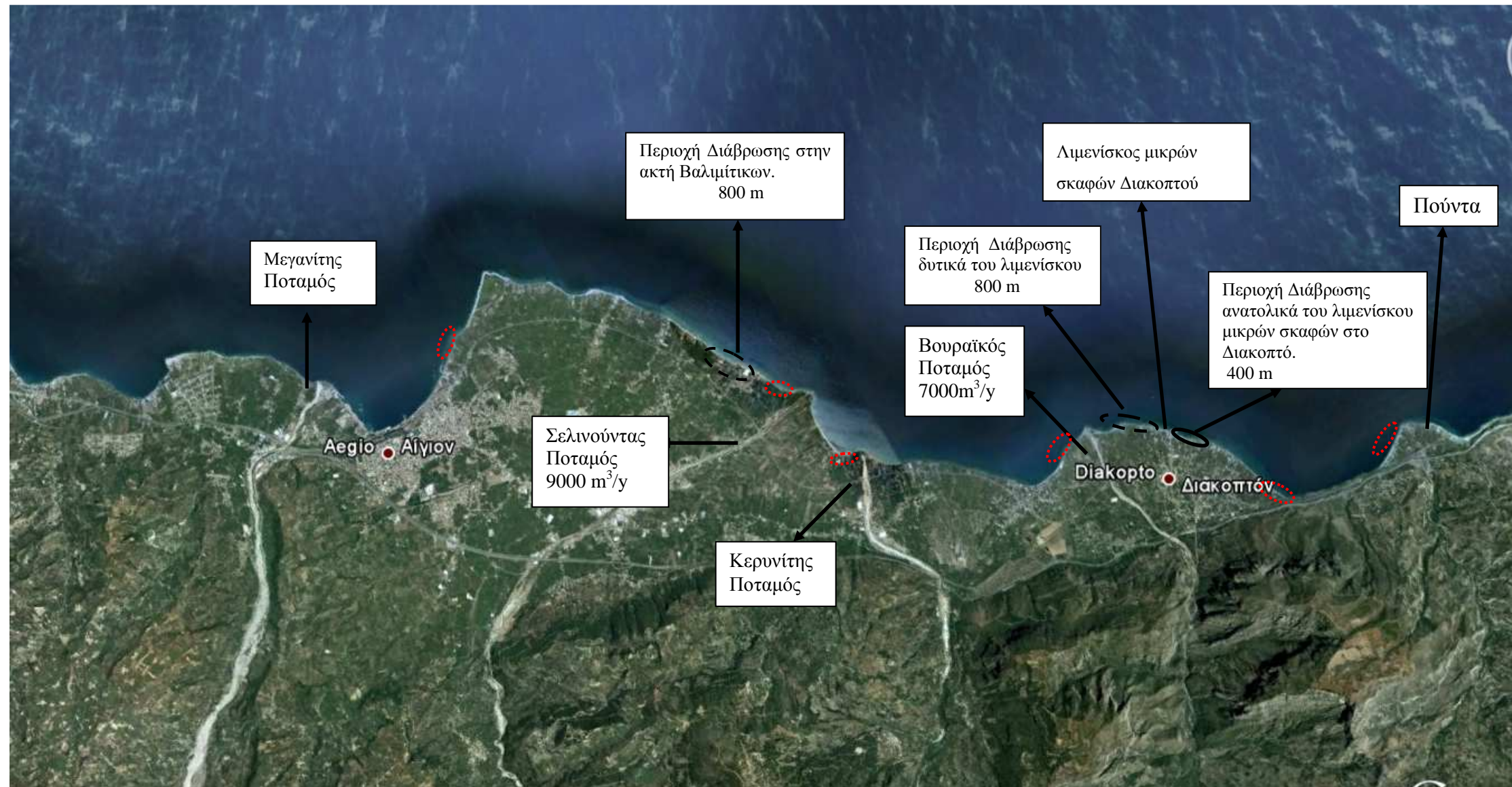
Εικόνα 4: Φαίνονται οι περιοχές του Διακοπτού και του Αιγίου με καταγεγραμμένα προβλήματα διάβρωσης από την Νομαρχία Αχαΐας (μαύροι διακεκομένοι κύκλοι), περιοχές με πρόβλημα διάβρωσης που έχουν επισημάνει περιβαλλοντικοί σύλλογοι και οργανώσεις (κόκκινοι διακεκομένοι κύκλοι) καθώς επίσης και οι πηγές ιζήματος της περιοχής (ποτάμια)
