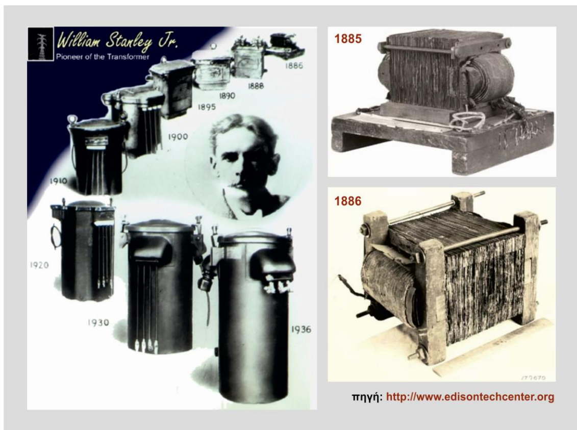
Σχήμα 26. Εξέλιξη στη μορφή των μετασχηματιστών από το 1886 ως το 1936
